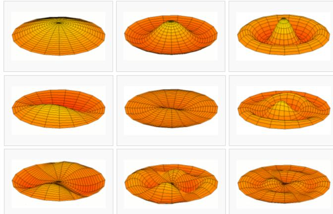
図 3: 円盤領域の固有モード (Vibrations of a circular membrane, In *Wikipedia, The Free Encyclopedia.*)
