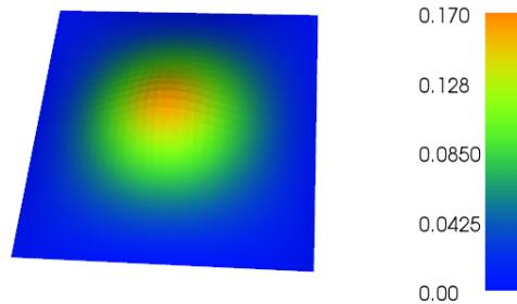
図 7: DOLFIN による Poisson 方程式の近似解
