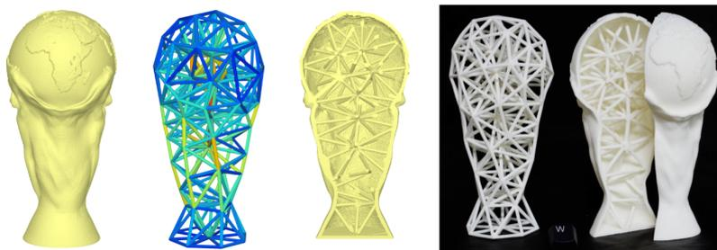
図 2 : 最適化されたモデルの内部構成とプリントされた実物
