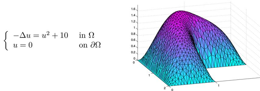
図 5: L-shape 領域における非線形微分方程式の解の検証例
