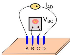
図 6: 4 探針法による抵抗率の測定
